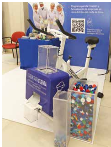
La Tritubike, creada por Plaka, es una bicicleta que tritura plásticos en cada pedaleada.
